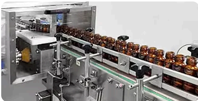
Linea automatica di riempimento e tappatura dei flaconi
