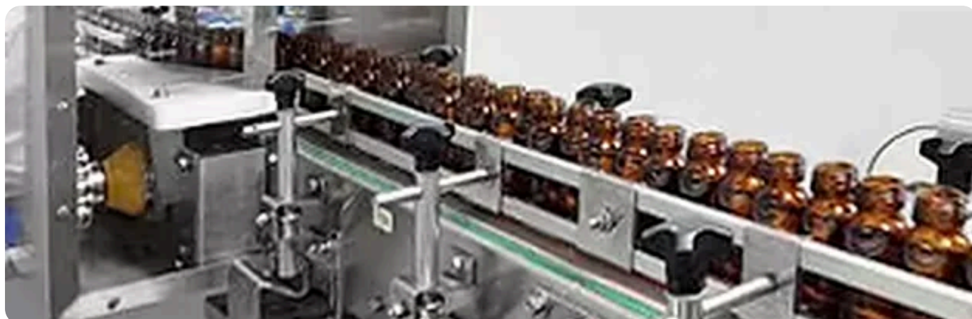
Ligne automatique de remplissage et de bouchage de flacons
