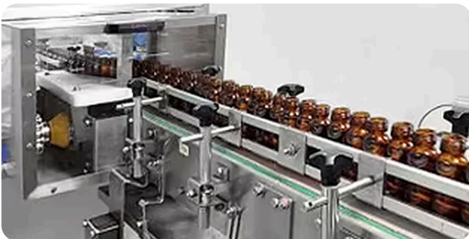
Ligne automatique de remplissage et de bouchage de flacons
