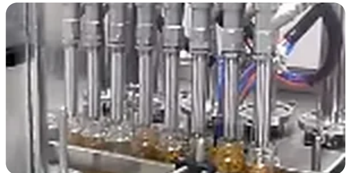
Boquillas de llenado de líquidos
