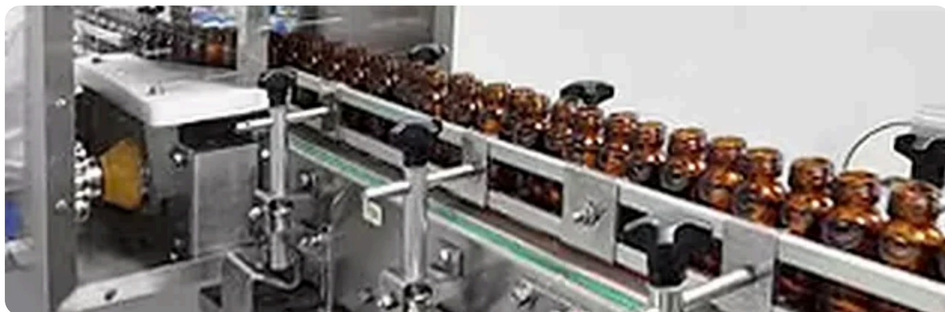
Línea automática de llenado y tapado de frascos
