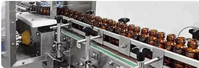
Automatische Flaschenbefüll- und Verschließlinie
