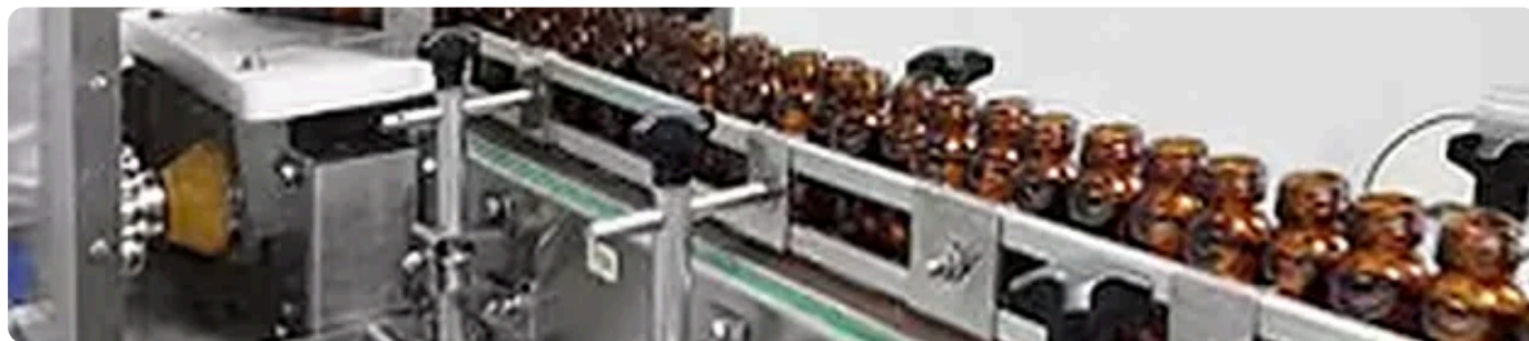
Automatische Flaschenbefüll- und Verschließlinie
